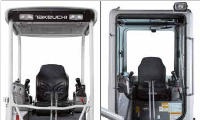
Fahrerschutzdach mit ROPS (ISO12117-2), TOPS (ISO12117), OPG (ISO10262 Stufe1) und Komfortsitz (wetterfeste Ausführung) mit Sicherheitsgurt.
