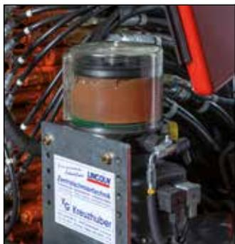
Mengengesteuerte Zentralschmieranlage mit Leerstandsmeldung
