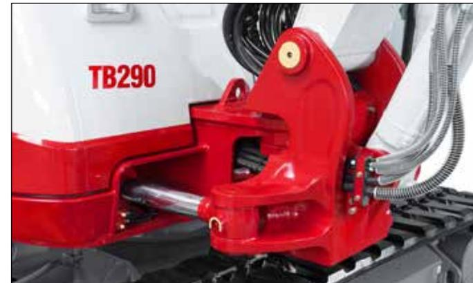
Robuster Schwenkbock. Schwenkzylinder, Hubzylinder und Stielzylinder mit Endlagendämpfung. Überlastwarnrichtung und Schlauchbruchsicherung.
