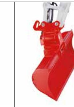
Starrer Grabenräumlöffel mit Power tilt-Schwenkvorrichtung
