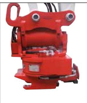
Rototop Drehvorrichtung mit Powertilt und hydr. Schnellwechselplatte
