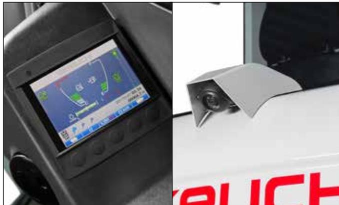
Neues, kratzfesteres Display aus anlauffresistentem Verbundglas, sowie ein Werkstattmenü mit neuen Funktionen. Einblendung der Rückfahrkamera ist ebenfalls möglich.
