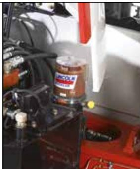
Mengengesteuerte Zentralschmieranlage mit Leerstandsmeldung
