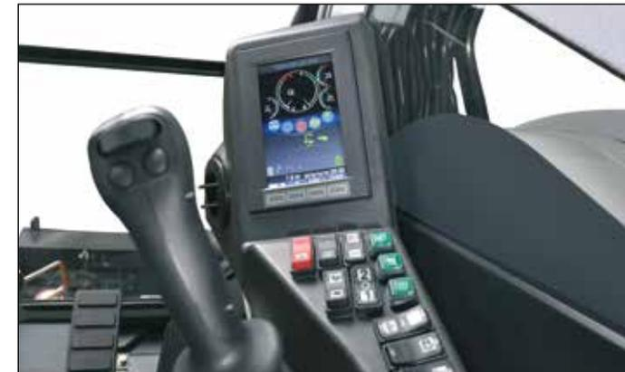
Display mit optischen und akustischen Überwachungseinheiten. Standardmäßig mit ECO-Betrieb; mit Powerknopf zur Erhöhung der Arbeitsleistung.
