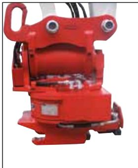
Rototop Drehvorrichtung mit Powertilt & hydr. Schnellwechselplatte und Huppi-Quick
