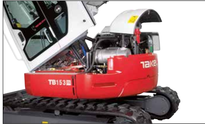
Kippbare Kabine mit servicefreundlichem Zugang zum Motor.
