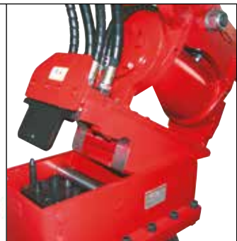
System Huppi-Quick: Hydraulikanschlüsse werden beim Schnellwechsellvorgang automatisch verbunden
